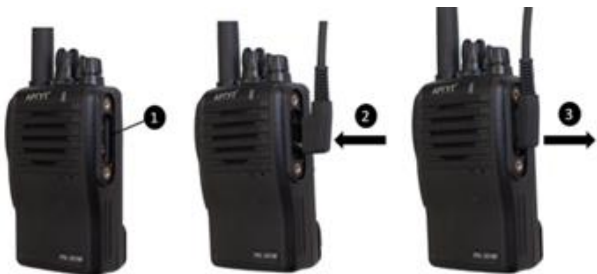
Рис. 6. Присоединение кабеля гарнитуры/ программирования.
