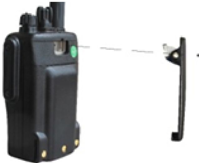
Рис. 5. Присоединение клипсы для крепления.
