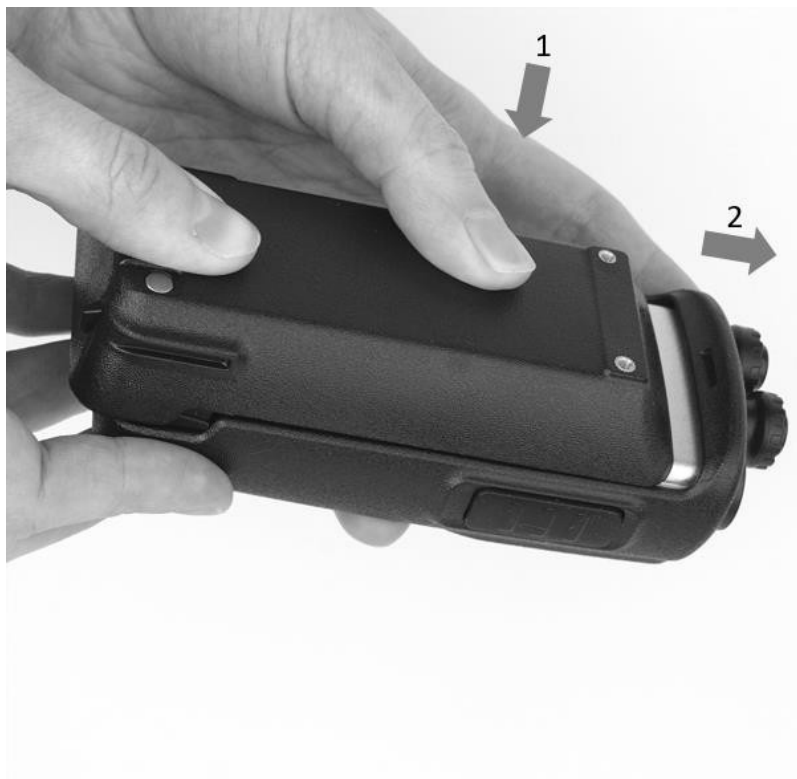
Рис. 2. Установка аккумуляторной батареи.
