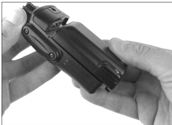
Рис. 2. Установка аккумуляторной батареи.
