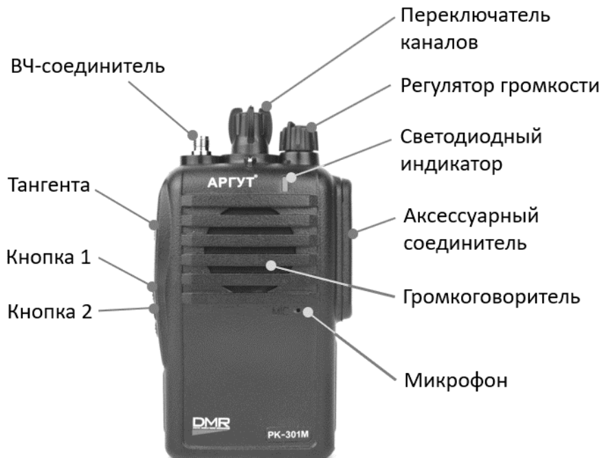
Рис. 1. Расположение органов управления, индикации и соединителей.
