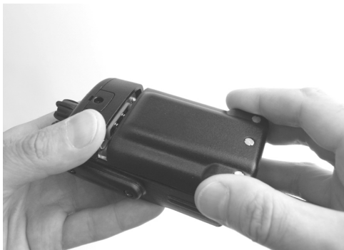
Рис. 3. Установка аккумуляторной батареи.
