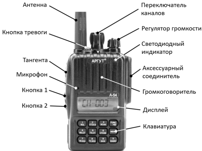
Рис. 1. Расположение органов управления, индикации и соединителей.
