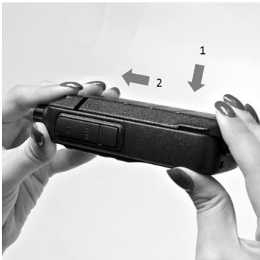
Рис. 2. Установка аккумуляторной батареи.
