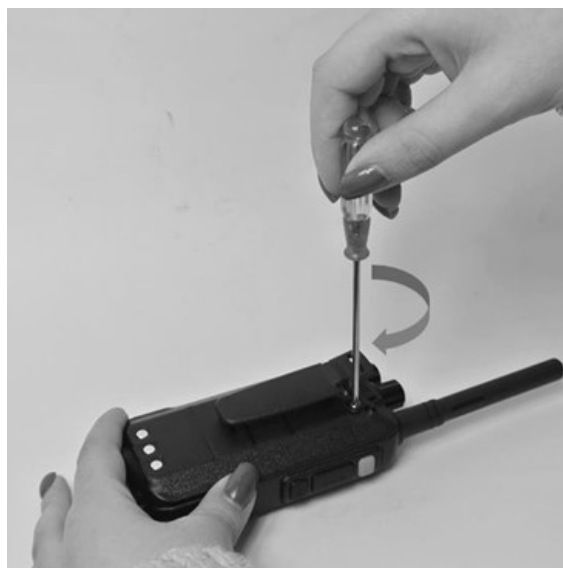
Рис. 5. Присоединение клипсы для крепления.
