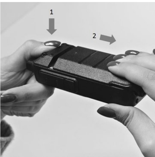
Рис. 3. Снятие аккумуляторной батареи.
