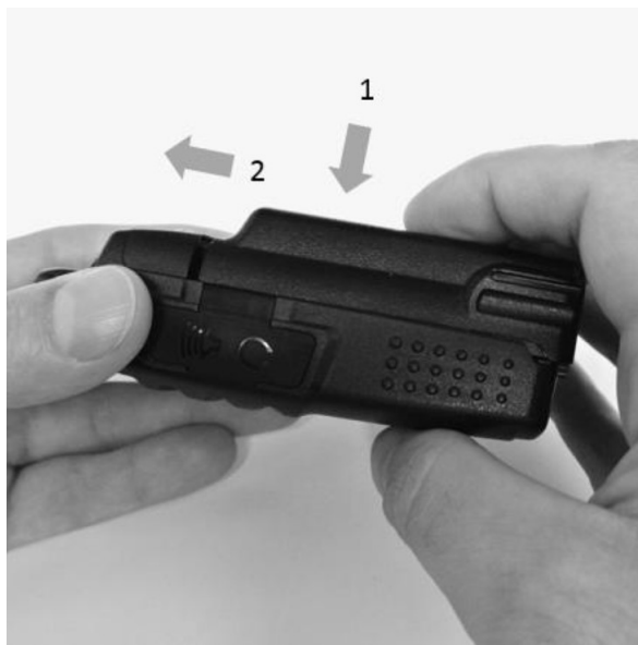
Рис. 2. Установка аккумуляторной батареи.
