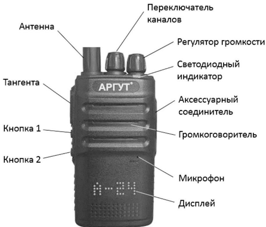
Рис. 1. Расположение органов управления, индикации и соединителей.
