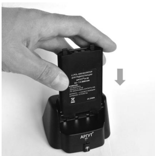
РИС. 7. Установка аккумуляторной батареи на зарядную базу.
