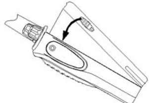
Установите блок аккумуляторов в паз в нижней части корпуса, добейтесь совпадения направляющих и прижмите его к трансиверу до щелчка.
