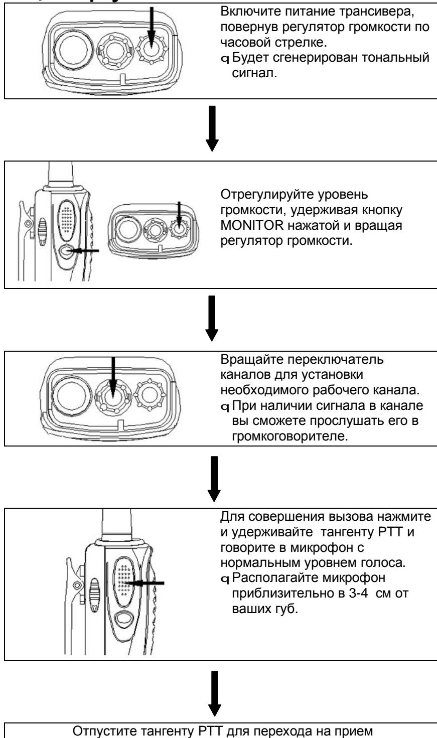
**Примечание.** Если напряжение аккумуляторов снизится до предельного уровня, то работа на передачу будет приостановлена, а индикатор будет мерцать красным цветом.
